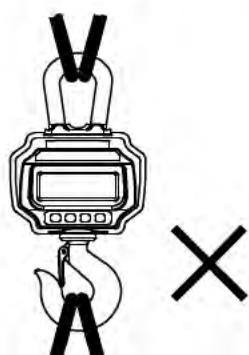
**Använd fästkedjor/linor så att det bildas enpunktsfästande!**
