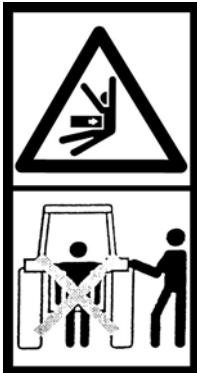
Gå inte nära hydraullyftens stänger vid användning av hydraullyften (på ovansidan av kroken på nedre bommen).
