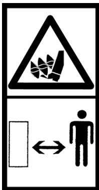
Håll ett säkert avstånd till snöslungans roterande rotor (till höger på rotorskyddet).
